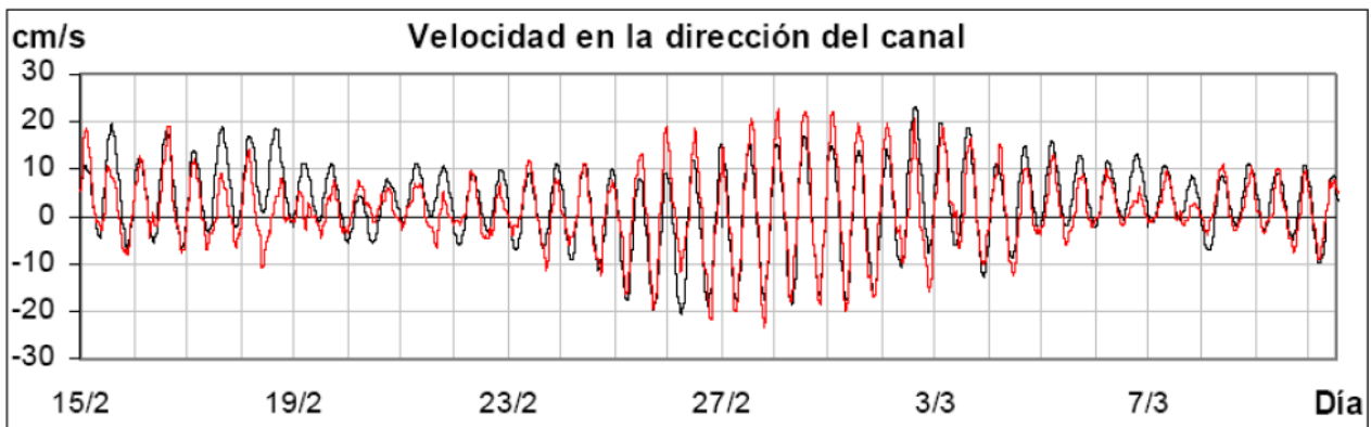
FIGURA 2.13 VELOCIDAD DE CORRIENTE, MEDIDA (ROJO). MODELADA (NEGRO). VALORES POSITIVOS INDICAN ENTRADA DE AGUA
