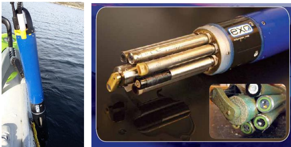
Vista de sonda multiparamétrica YSI- EXO2 utilizada para las determinaciones in situ y detalle de la misma
