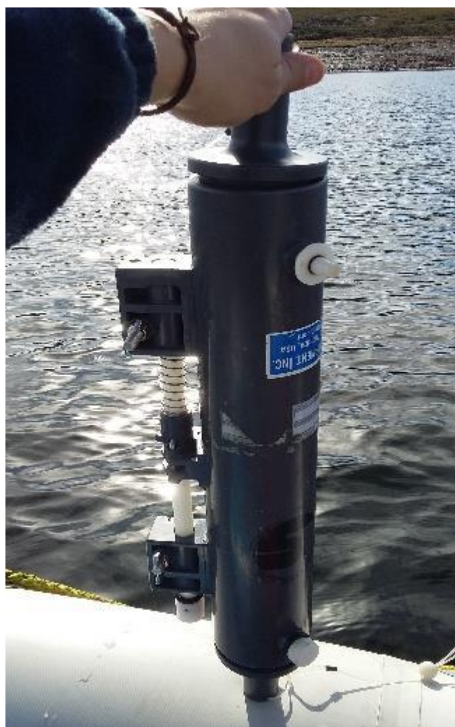
Vista de la botella hidrográfica tipo NISKIN
