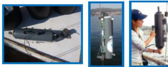
Botella oceanográfica toma muestras tipo Niskin
